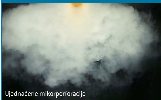
Primjeri strujanja zraka dobiveni dimnim testovima u Prihodinom odjelu za istraživanje i razvoj
